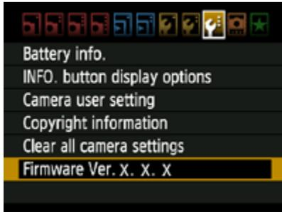
Haga girar el Selector Principal y el Selector de Control Rápido para seleccionar el ítem "Firmware Ver.x.x.x" en la parte inferior de "Set-up 3 (color amarillo)" y luego presione el botón <SET> (Fijar).
