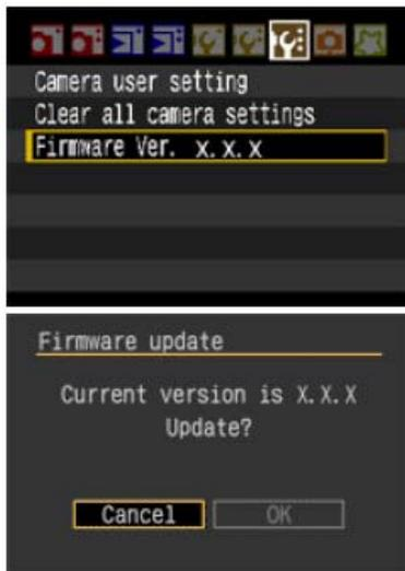
Haga girar el Selector Principal y el Selector de Control Rápido para seleccionar "Firmware Ver.x.x.x" al final de la configuración 3 (en amarillo) y luego presione el botón <SET> (Fijar).
